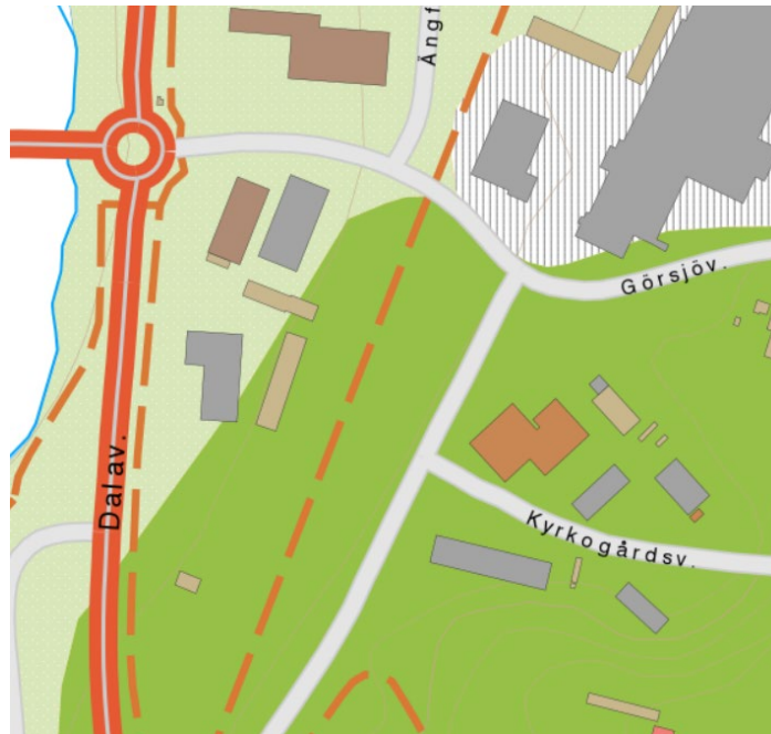
Jordartskarta: mörkgrönt = isälvsediment, ljusgrönt = glacial grovsilt-finsand, skrafferat = fyllning
