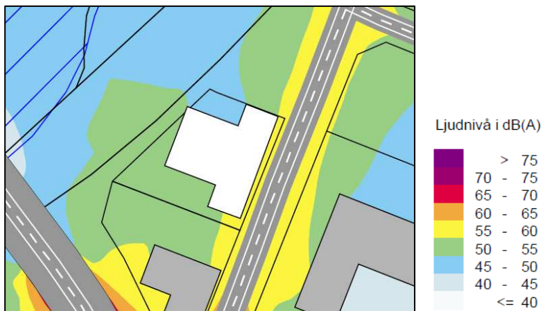
Figur 5. Utbredning av ekvivalent ljudnivå. Gemensam uteplats kan anordnas mot byggnaden där ljudnivån understiger 50 dB(A), blåa ytor.
