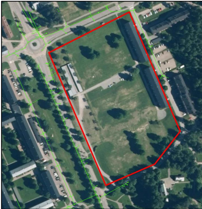
Figur 8. Befintliga dagvattenledningar (grönt), Hagfors kommun.
